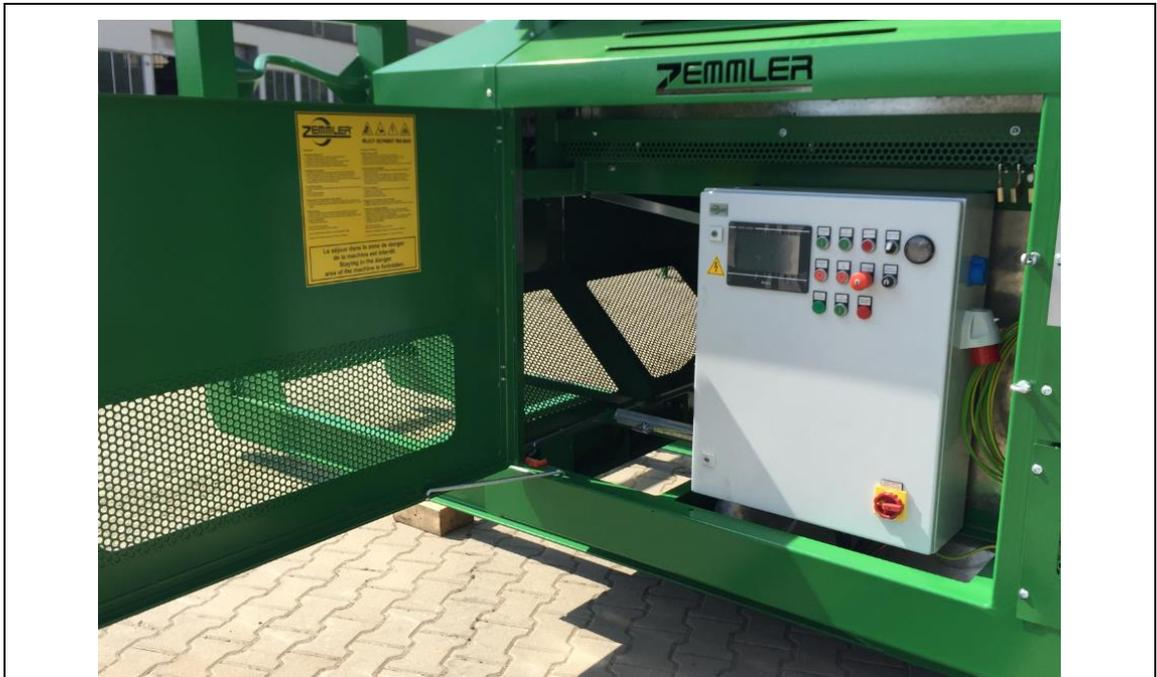
Fig. 8-4 Porte de commande ouverte
