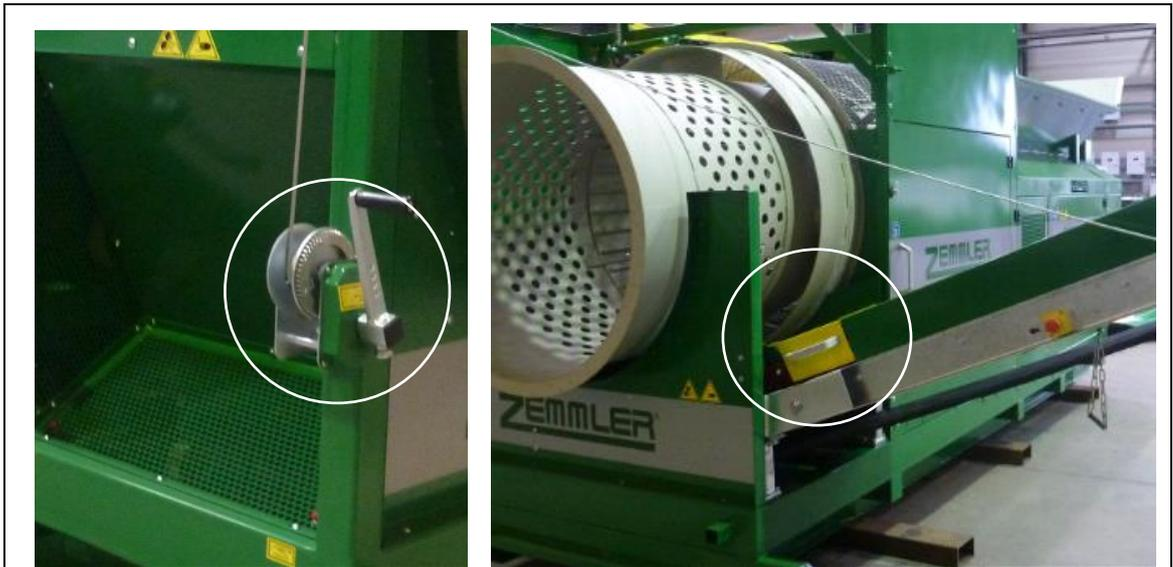
**Fig. 8-2: Le treuil et les plaques de guidage de la fraction grossière**
