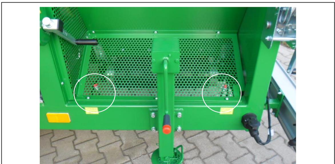
Fig. 11-7: Position de graisse de lubrification de fraction grossière
