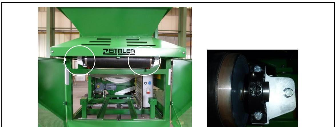
**Fig. 11-8: Position de graisse de lubrification du convoyeur d'alimentation**
