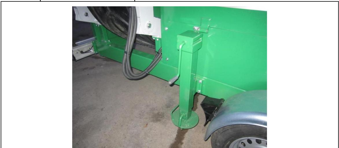
Fig. 7-1: Supports latéraux en position de transport
