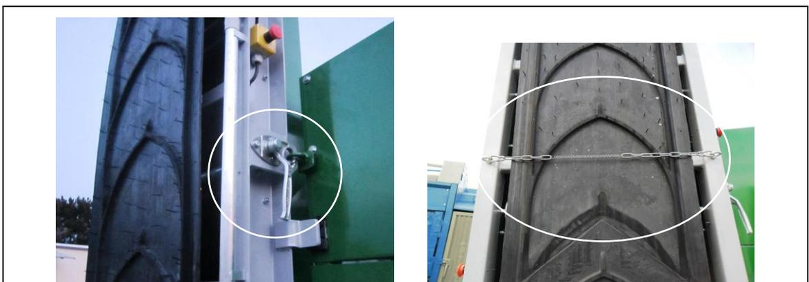
**Fig. 7-3: Sécurité de transport fraction grossière**
