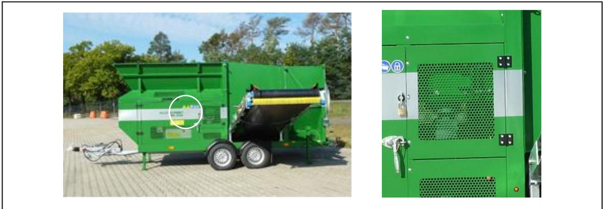
**Fig. 3-3: Capot de protection galet de commande avec des éléments fusibles**
