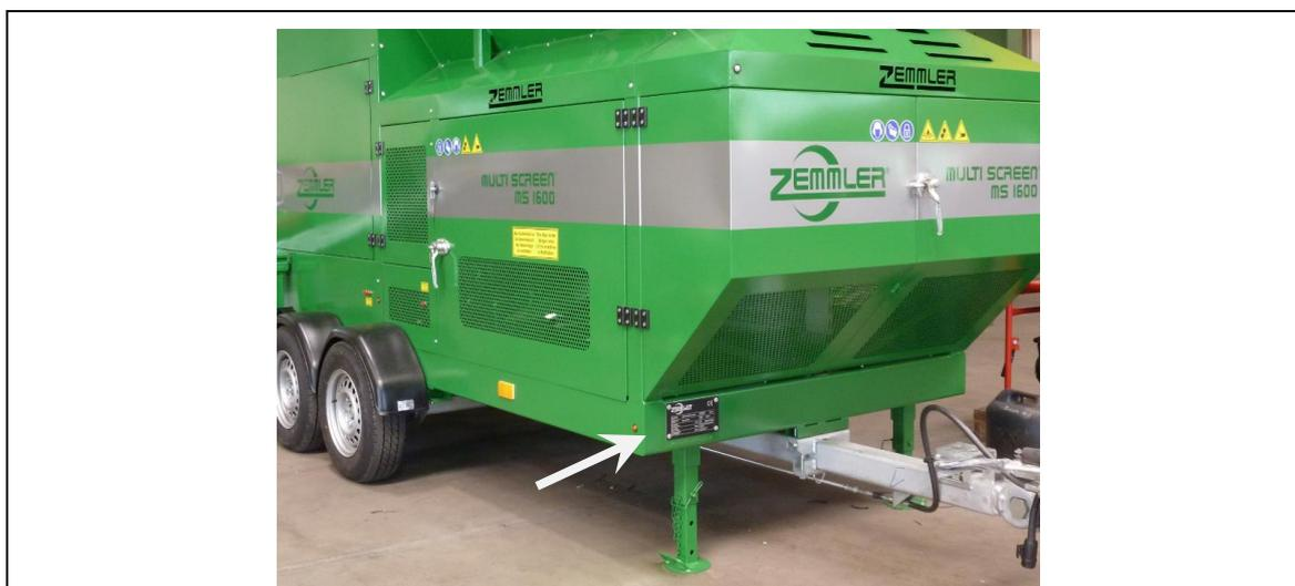
Fig. 12-4: Position de la plaque signalétique
