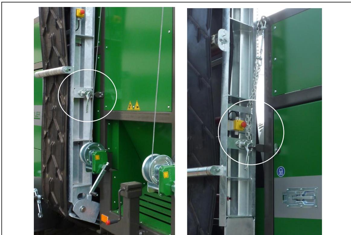
Fig. 7-4: Sécurité de transport 1. et 2. fraction
