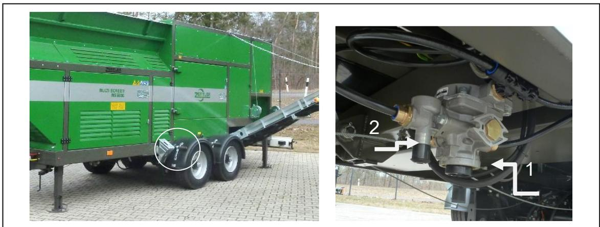
**Fig. 5-1: le système de freinage et La soupape de desserrage**
