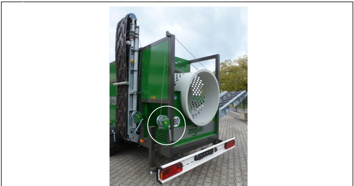
Fig. 8-2: Le treuil de la 2.fraction
