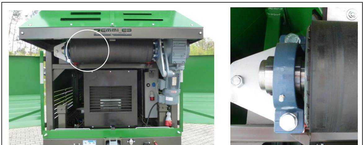
**Fig. 11-10: Position de graisse de lubrification du convoyeur d'alimentation**
