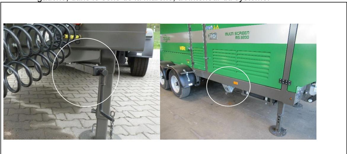
Fig. 7-1:: Position Frein de stationnement et support de sabot de frein
