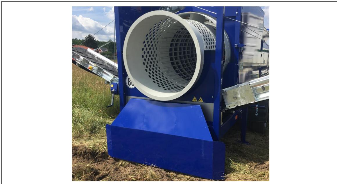
Fig. 8-4: Position de la tôle de déflecteur
