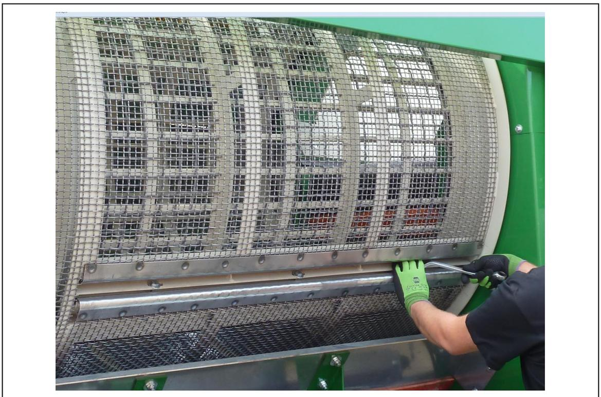
**Fig. 11-3: Station de tension du tamis extérieur**
