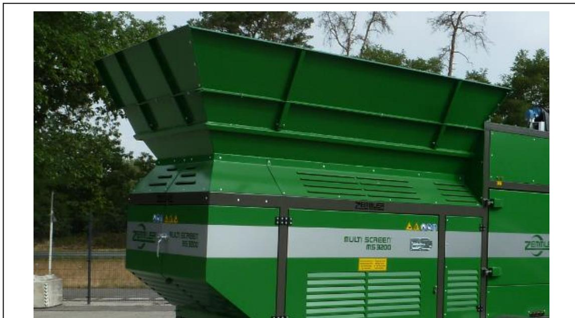
**Fig. 11-12: trémie supplémentaire montée (exemple)**
