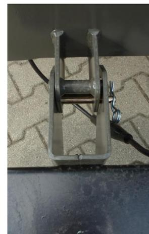
Fig. 7-3 : Débrancher l'unité de sécurité ainsi que l'alimentation électrique de la rampe d'éclairage
