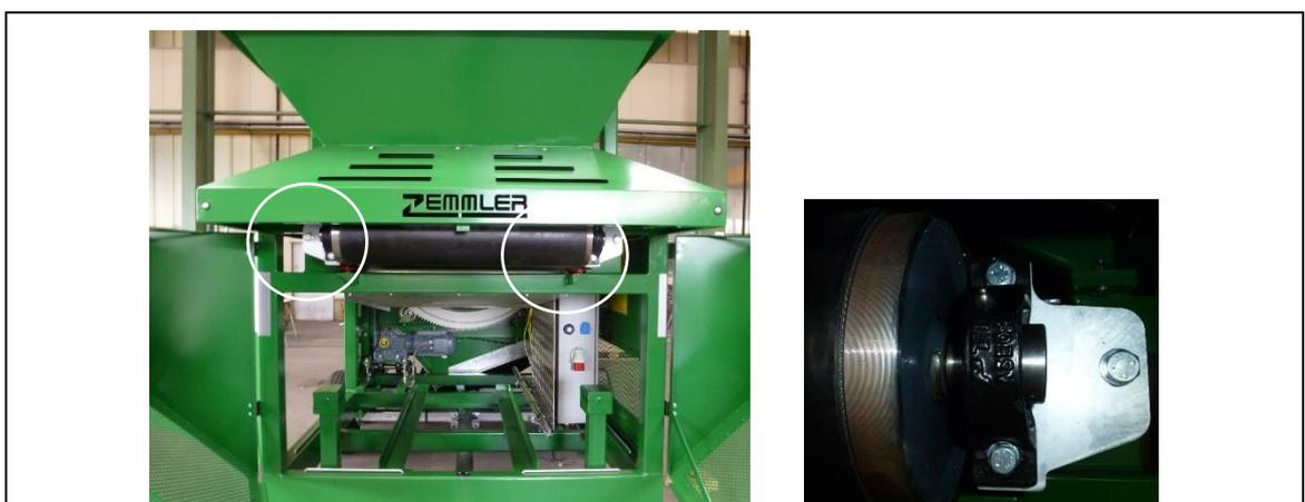
Fig. 11-9 : Position des points de lubrification sur le distributeur de bande
