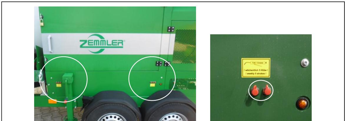
Fig. 11-7 : Position des points de lubrification des rouleaux porteurs
