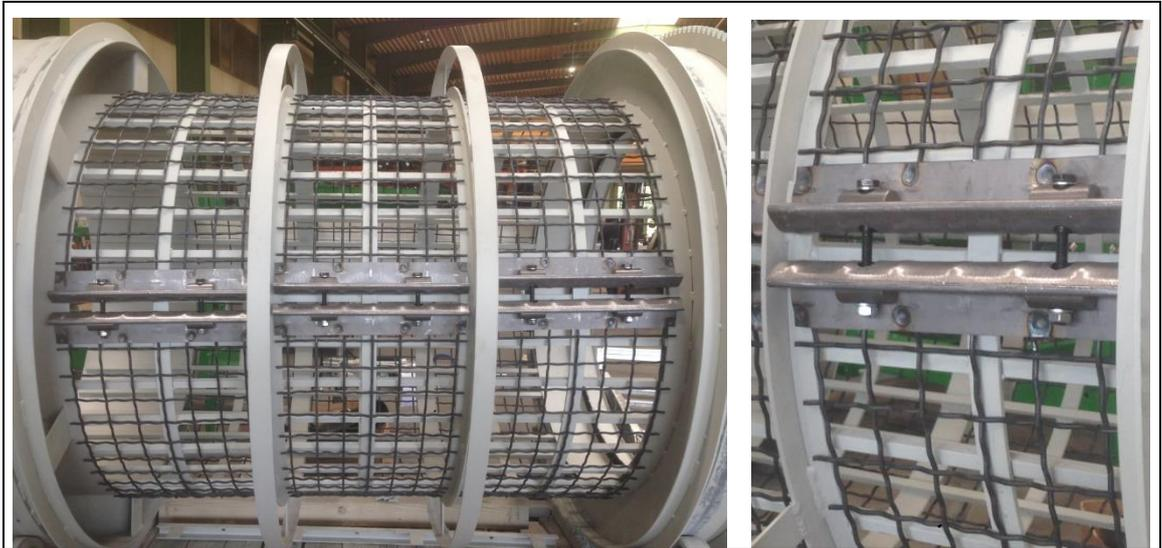
**Fig. 11-5 : Dispositif de serrage pour le tamis intérieur**
