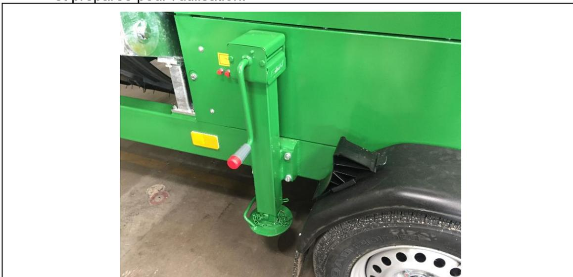
Fig. 7-1 : Appui arrière du crible en position de transport
