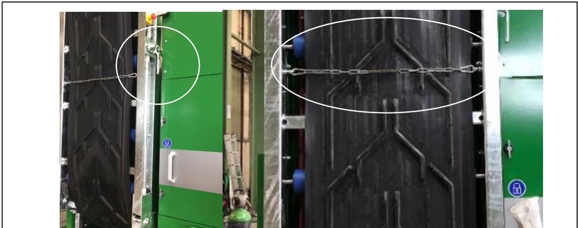
Fig. 7-3 : Sécurisation du transport de la 2. Fraction
