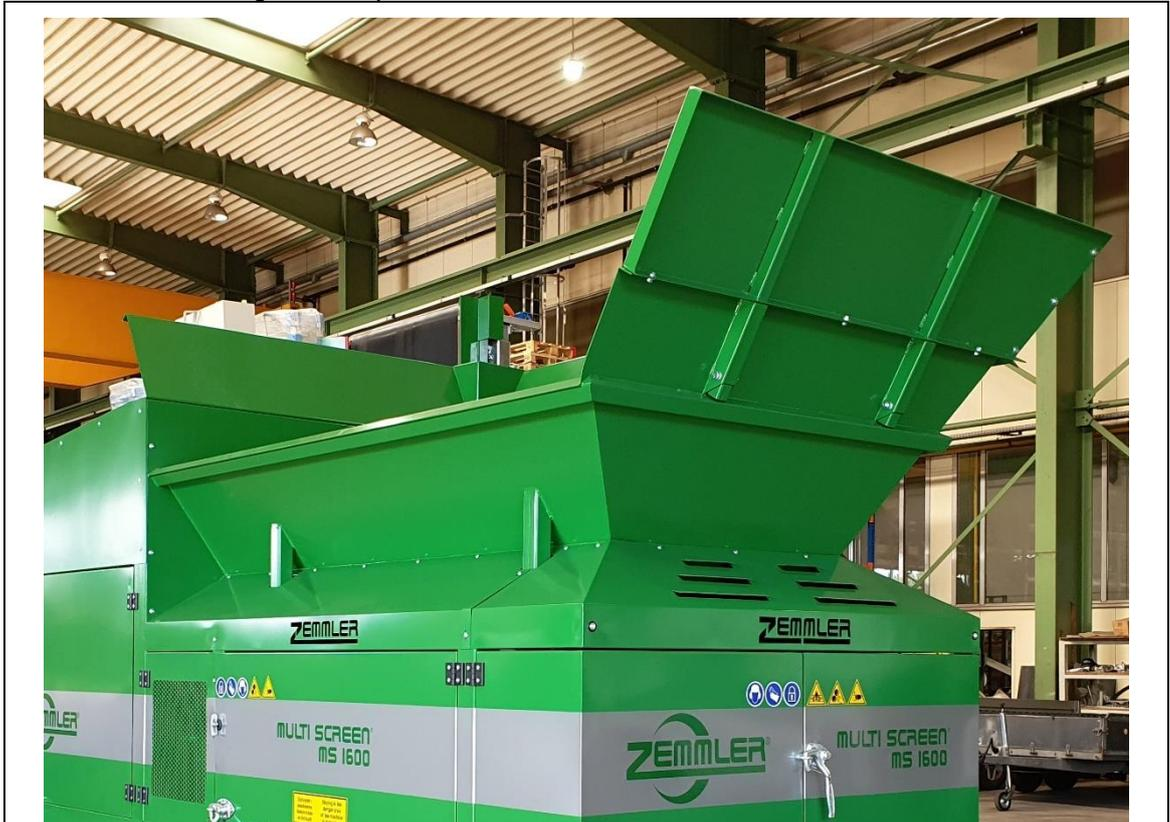
Fig. 11-10 : Ajout de trémie monté
