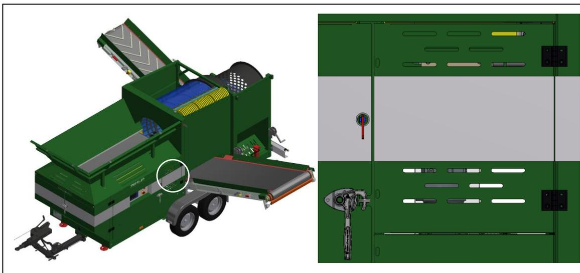
**Fig. 3-3 : Protection d'intervention Rouleaux de commande avec élément de sécurité**
