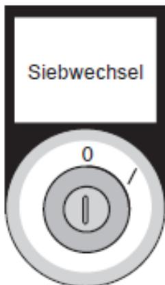
Activer le changement de tamis avec l'interrupteur à clé MS2 sur l'unité de commande. Pour cela, placer l'interrupteur à clé sur « I ».
