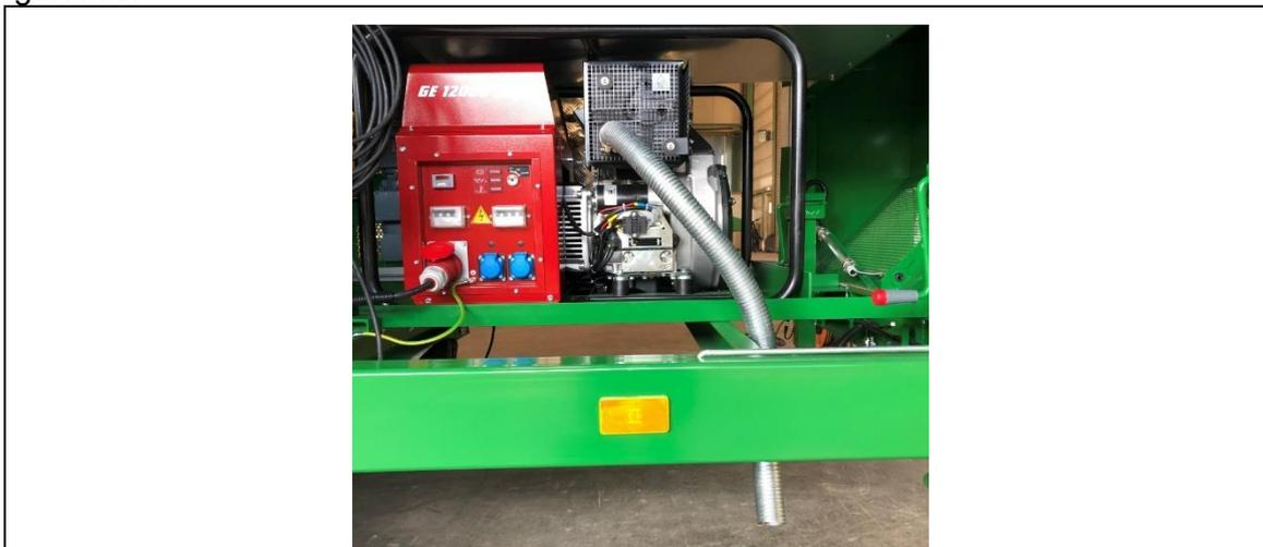
Fig. 8-3 Exemple de pose du tuyau d'échappement
