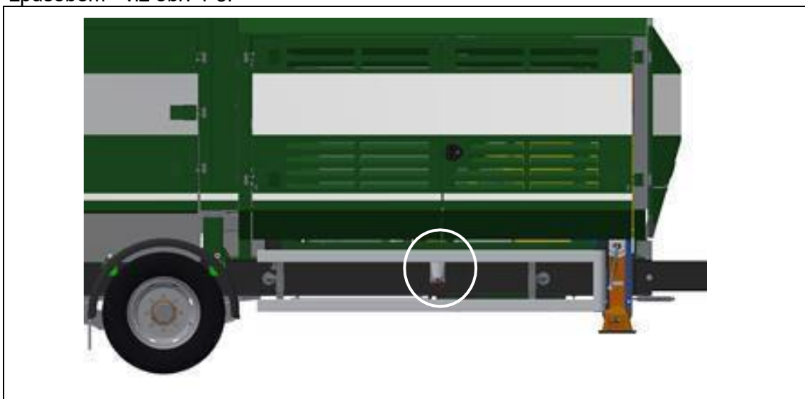
Obr. 4-2: Pevné síťové připojení 400V zásuvky CEE63A
