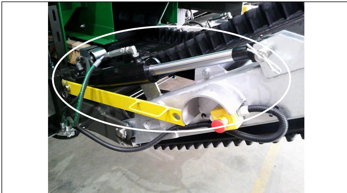
Obr. 7-6: Transportní pojistka střední frakce
