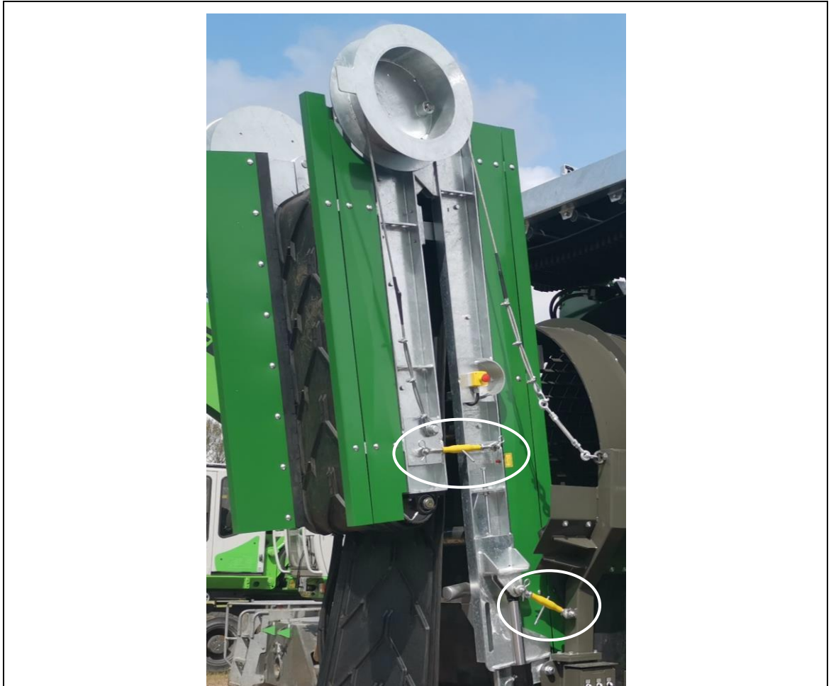
Obr. 7-9: Transportní pojistka prodlouženého dopravníku hrubé frakce
