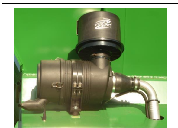
Obr. 11-6: Vzduchový filtr se zařízením TopSpin PreCleaner
