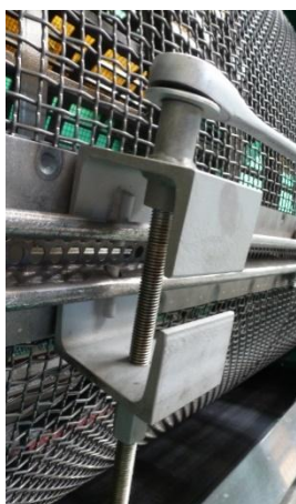
Obrázek 84: Napínání síta pomocí upínací pomůcky
