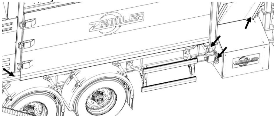
Obrázek 97: Pozice mazacích bodů na levé straně krytu (31,32,33,37,38,41,42)
