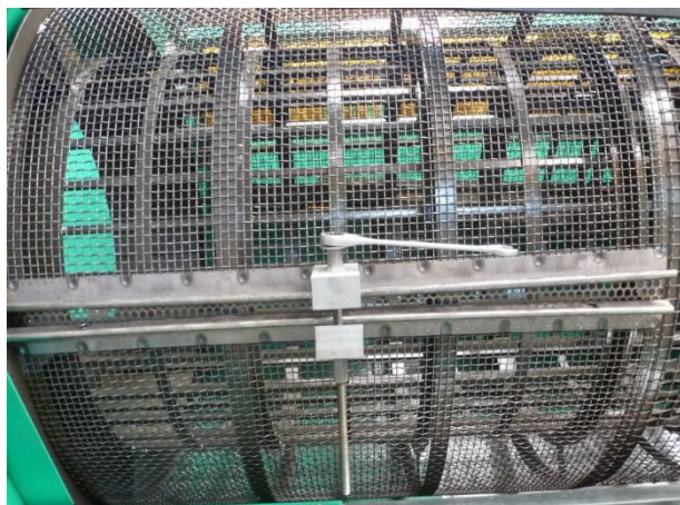
Obrázek 84: Napínání síta pomocí upínací pomůcky
