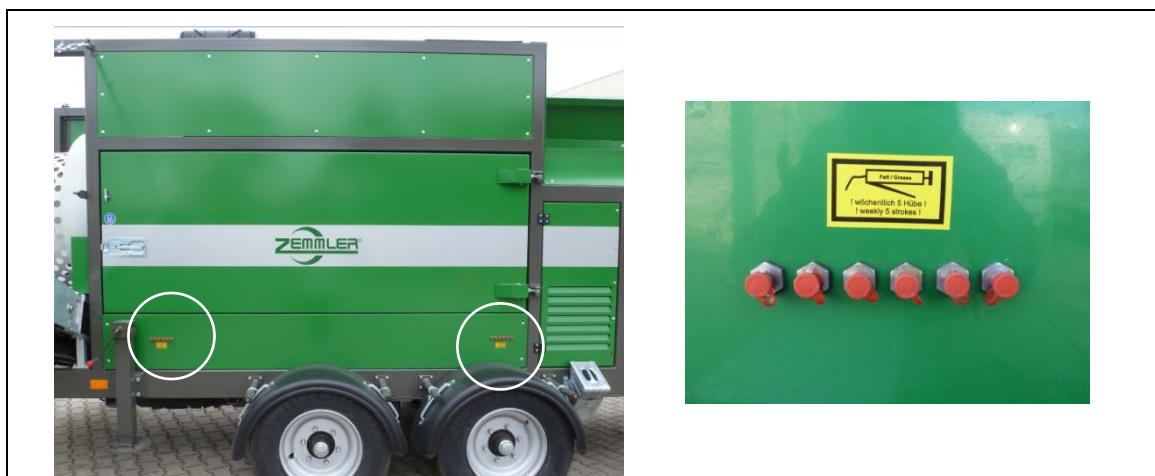
Obr. 11-9: Umístění centrálních mazacích bodů
