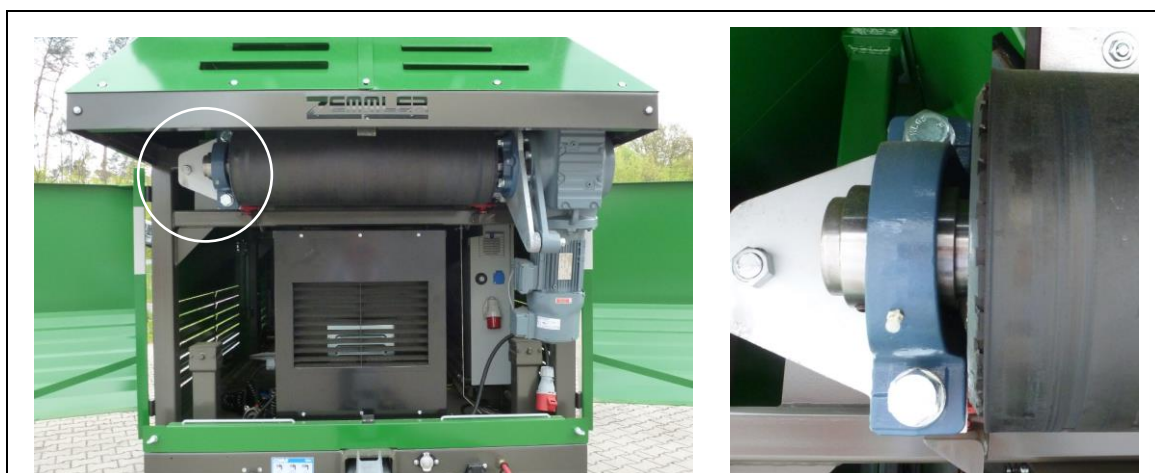
Obr. 11-10: Umístění mazacích bodů na pásovém podavači
