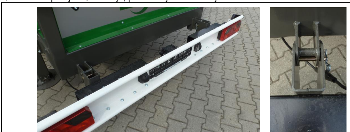
Sl. 7-3: Otpustite jedinicu osigurača, kao i napajanje svjetlosne trake
