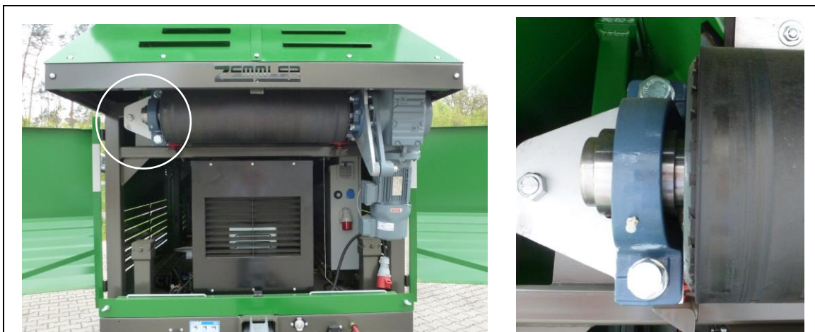
Sl. 11-9: Položaj mjesta podmazivanja na ulagaču trake
