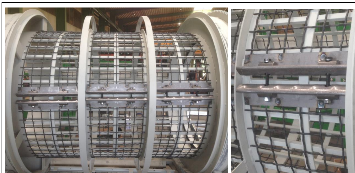
Sl. 11-5: Stezna sprava za unutarnje sito
