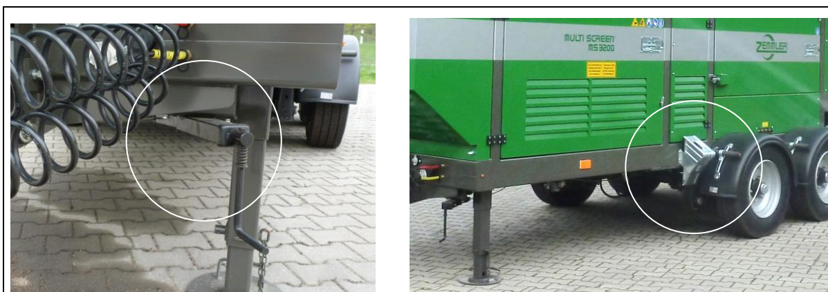
Sl. 7-1: Položaj parkirne kočnice i držača papučice kočnice
