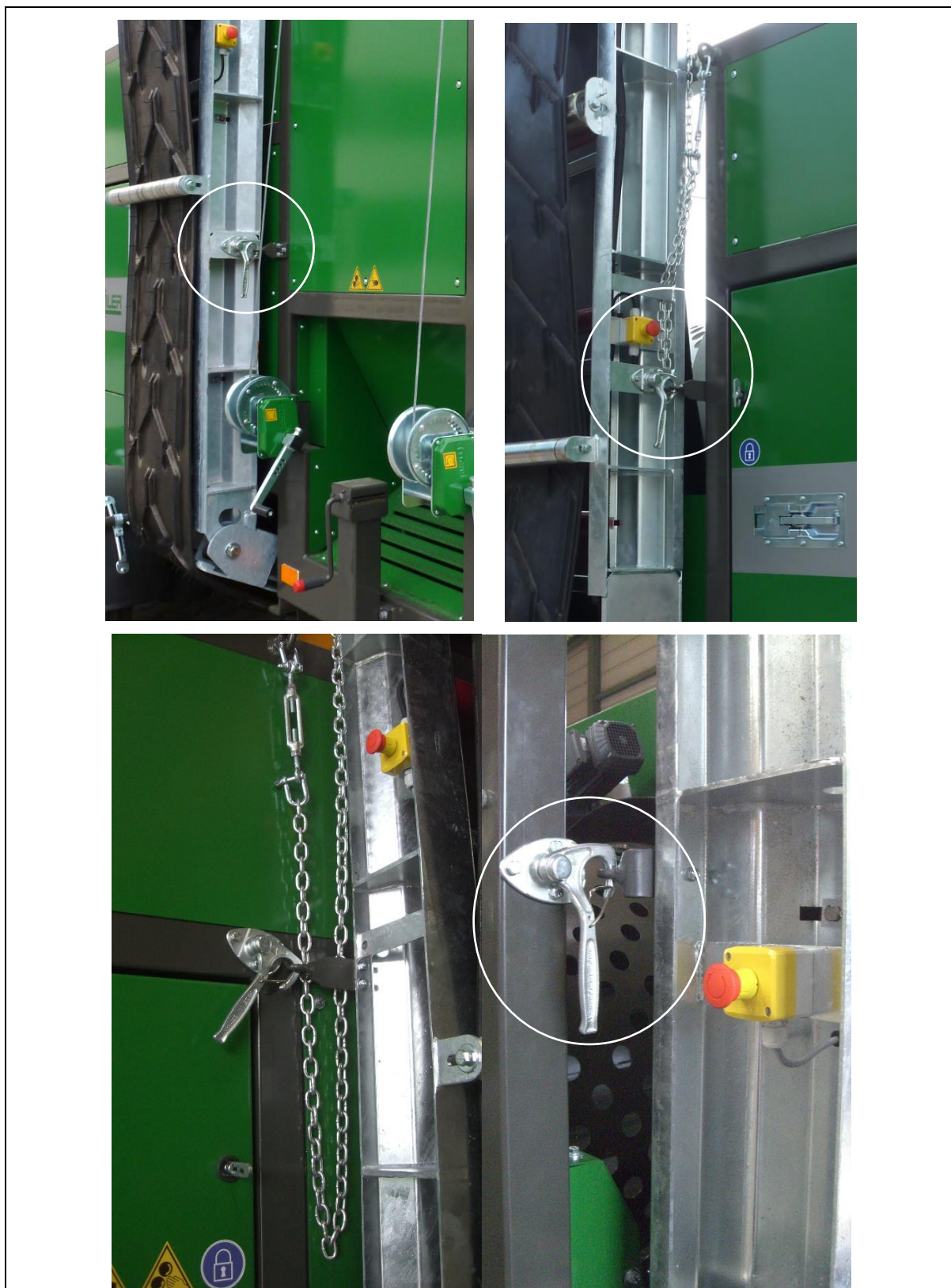
Sl. 7-4: Transportno osiguranje finih frakcija / srednji frakcija
