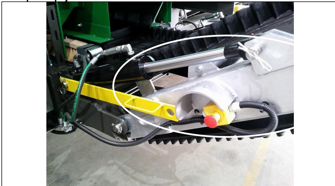
Abr. 7-5: Transportní pojistka střední frakce
