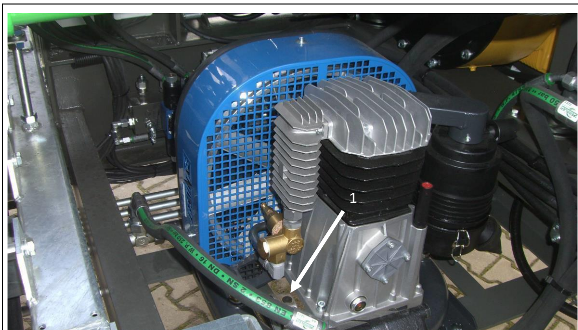
Obr. 11-8: Kompresor v motorovém prostoru
