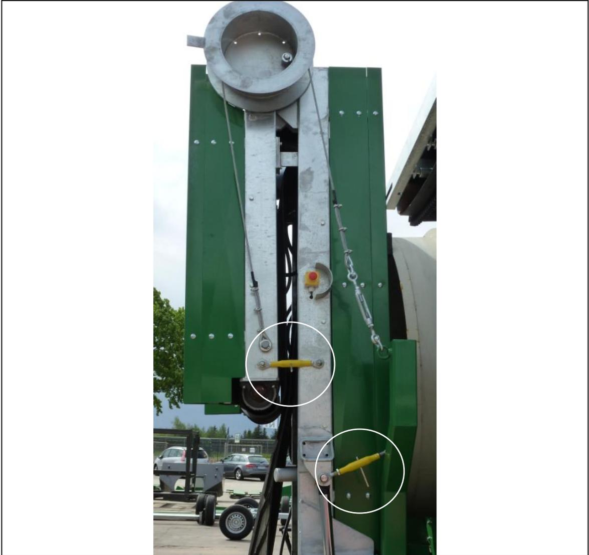
**Fig. 7-7: Fissaggio per il trasporto del frazionamento grossolano prolungato**
