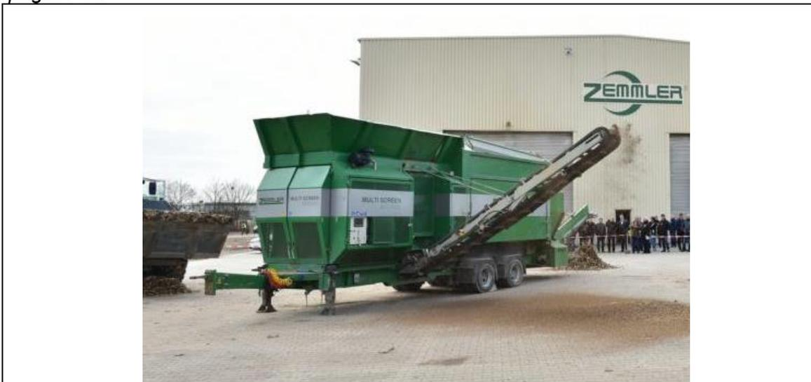
**Fig. 6-1: Esempio impianto di vagliatura in posizione di lavoro (anteriore sinistro)**
