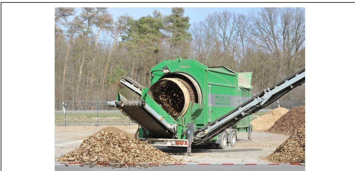
**Fig. 6-2: Esempio impianto di vagliatura in posizione di lavoro (posteriore destro)**
